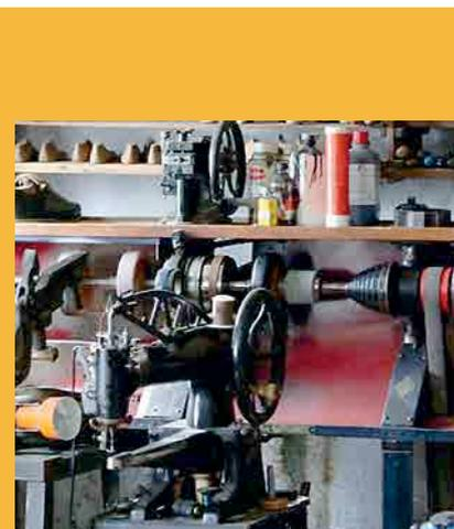
Raspeln, Querahlen, Randmesser, Holz- und Metallnägeln aller Größen, Schleifscheiben, Dreifuß, Leistenfräsen, Steppnähmaschinen, eine Vorschleif- und Ausputzmaschine, eine Doppelmaschine für Zwiennähte und eine aus dem Jahr 1931 stammende Ledernähmaschine der Marke „Adler“.
